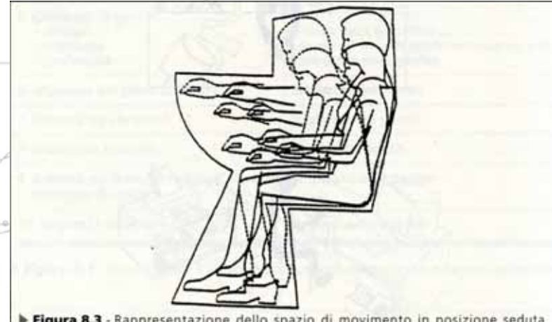
► Figura 8.3 - Rappresentazione dello spazio di movimento in posizione seduta. La rappresentazione riporta lo spazio di movimento riferito al 5° e al 95° percentile. Da: Norma prEN ISO 14738/1999 (Final draft)
